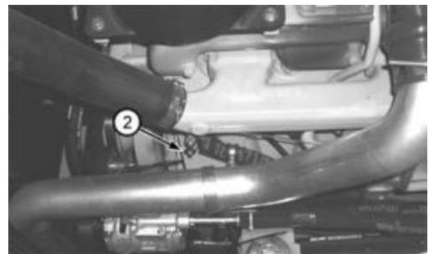
Сливная пробка двигателя—двигатель Tier 2/Stage II
