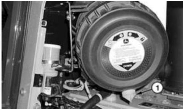
Клапан пылевытаскивающего устройства — двигатель Tier 3/Stage III A объемом 9,0 л
