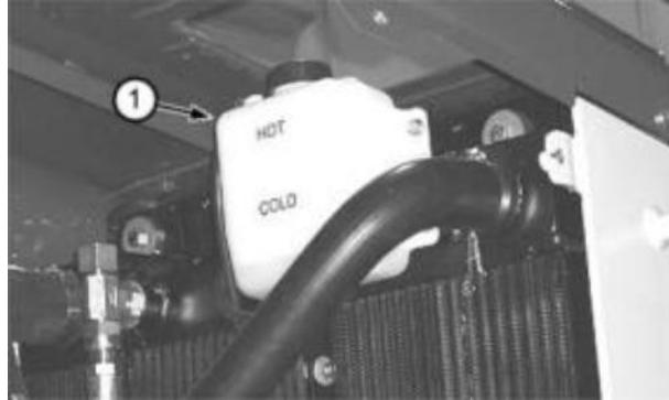
Показан бак регенерации охлаждающей жидкости двигателя
