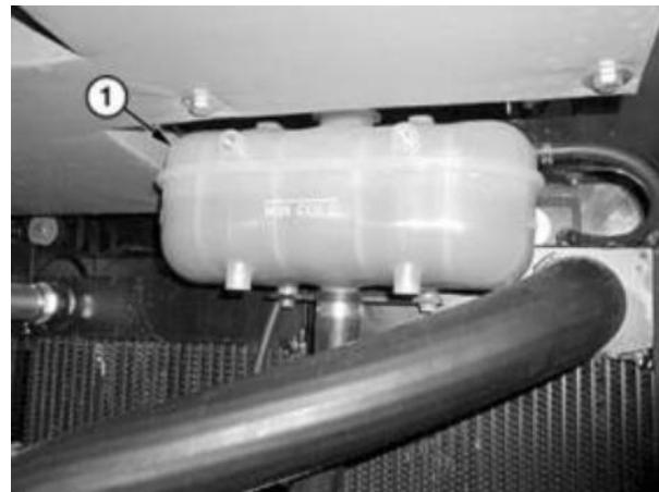
Показан расширительный бачок двигателя Tier 3/Stage IIIA объемом 9,0 л
