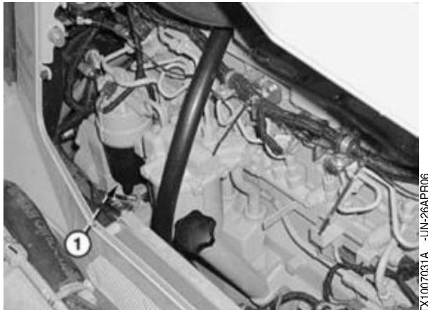
Осадок топливного фильтра — двигатель Tier 3/Stage III A объемом 9,0 л
