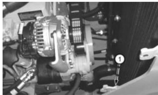
Кран радиатора — двигатель Tier 2/Stage II объемом 8,1 л
