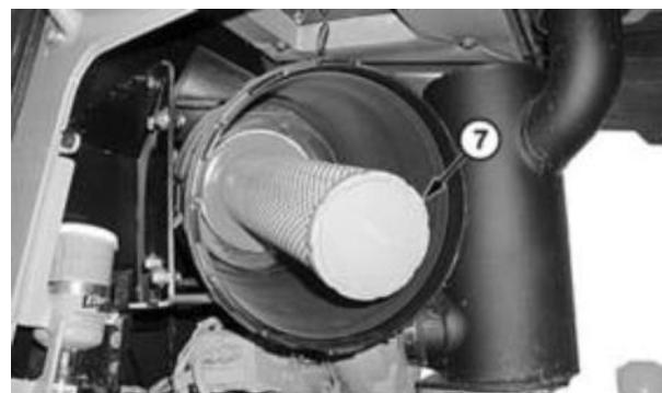
Вторичный элемент – двигатель Tier 3/Stage III A объемом 9,0 л
