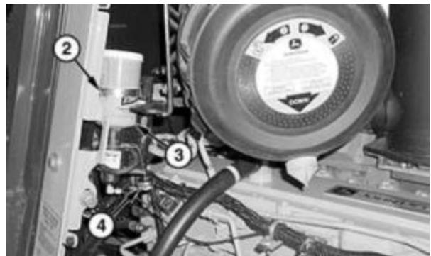
Контейнер пускового приспособления — показан двигатель Tier 3/Stage IIIA объемом 9,0 л
