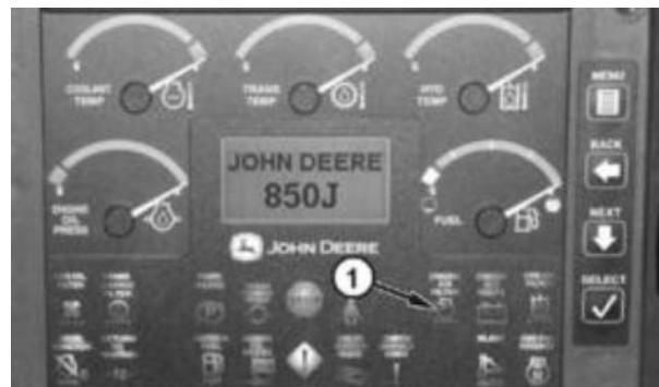
Индикатор закупорки воздушного фильтра двигателя
