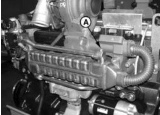
A – Вентиляционная пробка охладителя рециркулятора отработавших газов
