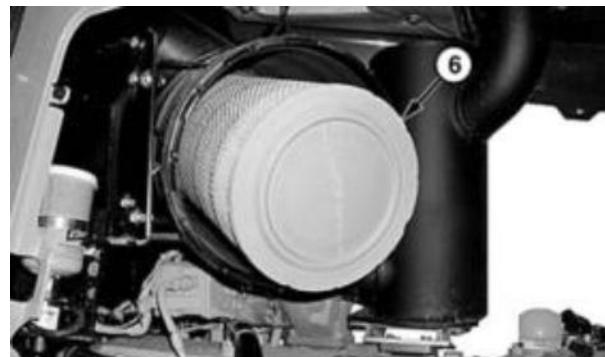
Первичный элемент – двигатель Tier 3/Stage III A объемом 9,0 л
