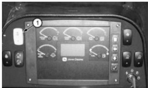
Переключатель вспомогательного пускового устройства
